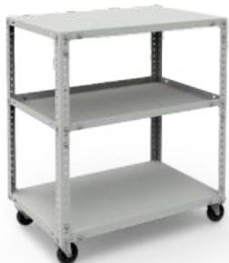
Стол полностью выполнен из листовой гнутой стали. Колесные опоры поворотные d=75 мм - 4 шт., 2 из них с тормозом. Имеется возможность регулировки верхней и средней полок по высоте.
